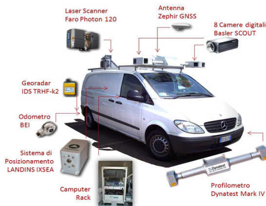
Figura 5 – Quadro d'insieme della strumentazione del veicolo MMS RoadScanner.
