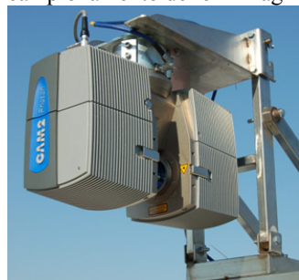
Figura 6 – Particolare del montaggio del LS.
