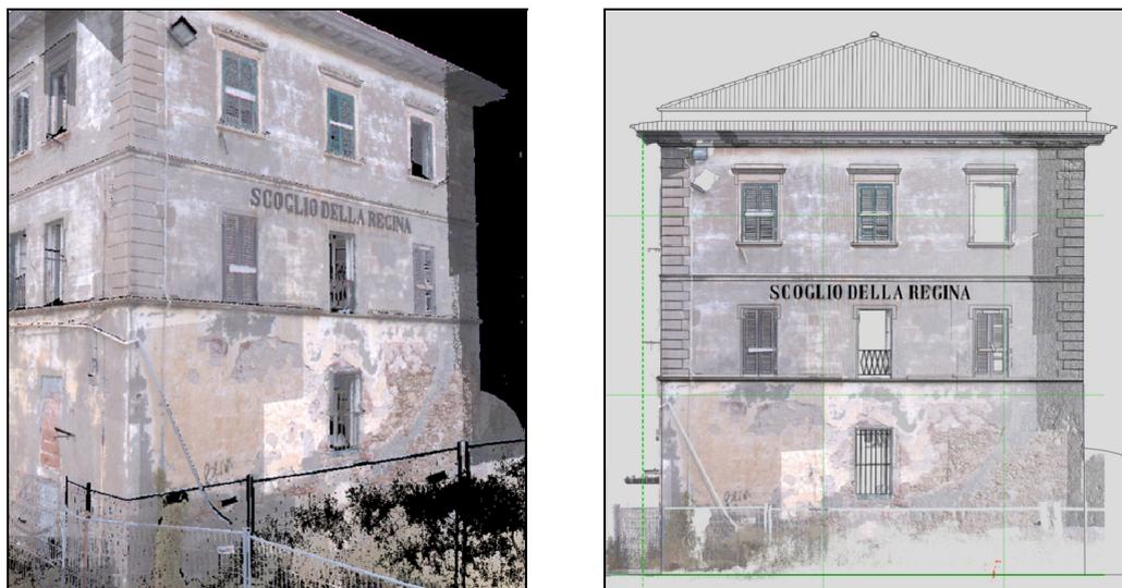
Figura 1 – Modello 3D a nuvola di punti e restituzione del prospetto principale.
