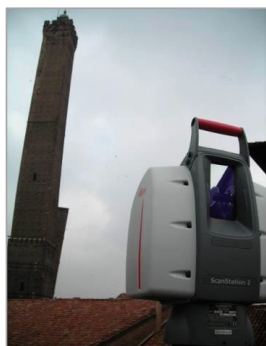
Figura 1 – Il Laser Scanner utilizzato: Scan Station 2.
