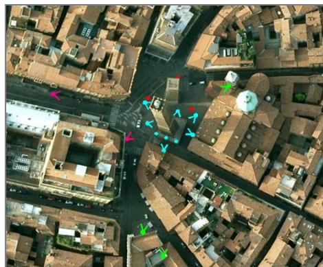
Figura 2 – Lo schema di acquisizione della Torre degli Asinelli (punti di presa in ciano, verde, fucsia) e della Garisenda (punti di presa in rosso).
