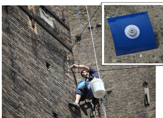
Figura 3 – L'applicazione dei target retro-riflettenti alle pareti della Torre degli Asinelli.
