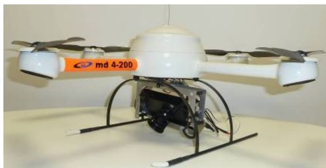
Figura 1 – Sistema di acquisizione di dati multispettrali di prossimità composto dal drone md4-200 e dalla Tetracam ADC lite.
