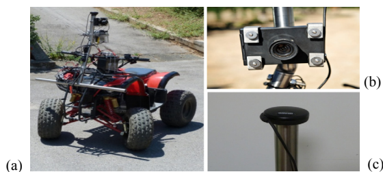
Figura 3 – Sistema di acquisizione MuLO - MULTispectral Land Observation costituito da un quad (a), una camera multi spettrale (b) ed un'antenna GPS (c).
