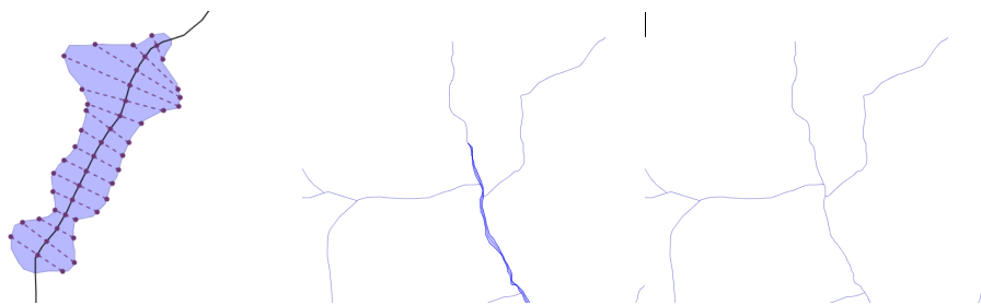
Figura 3 – A sinistra calcolo della larghezza media su una sezione di fiume tramite le normali all'asse; a destra il risultato della generalizzazione: il fiume viene collassato da area a linea perché troppo stretto.
