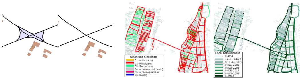
Figura 5 – A sinistra identificazione di un incrocio e generalizzazione, a destra arricchimento del modello dati originale.
