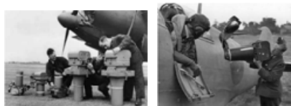
Figura 3 – Installazione delle fotocamere sui ricognitori R.A.F.
