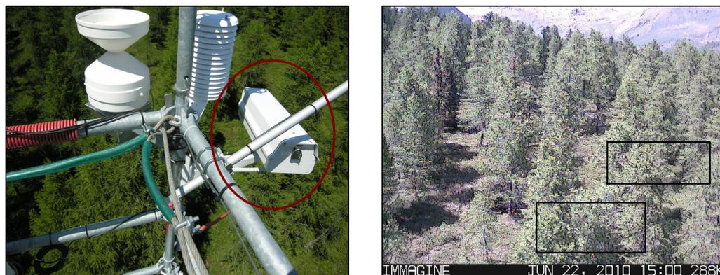
Figura 1 – a) Webcam modello CC640 installata presso il sito sperimentale di Torgnon (AO).
