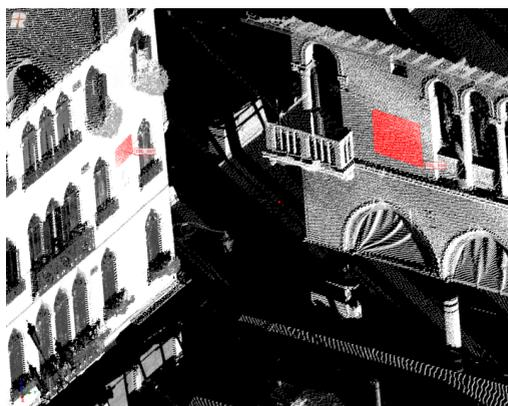
Figura 7 – Vista dei tie-plane (piani di controllo), colorati in rosso, utilizzati nella compensazione delle traiettorie.
