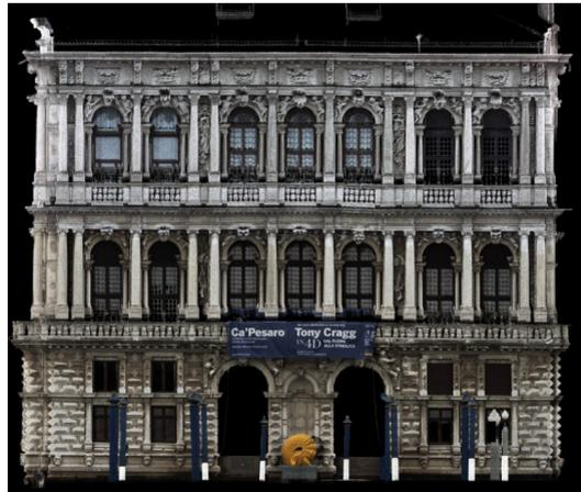
*Figura 12 – Simil ortofoto della facciata realizzata con le foto acquisite durante la scansione.*
