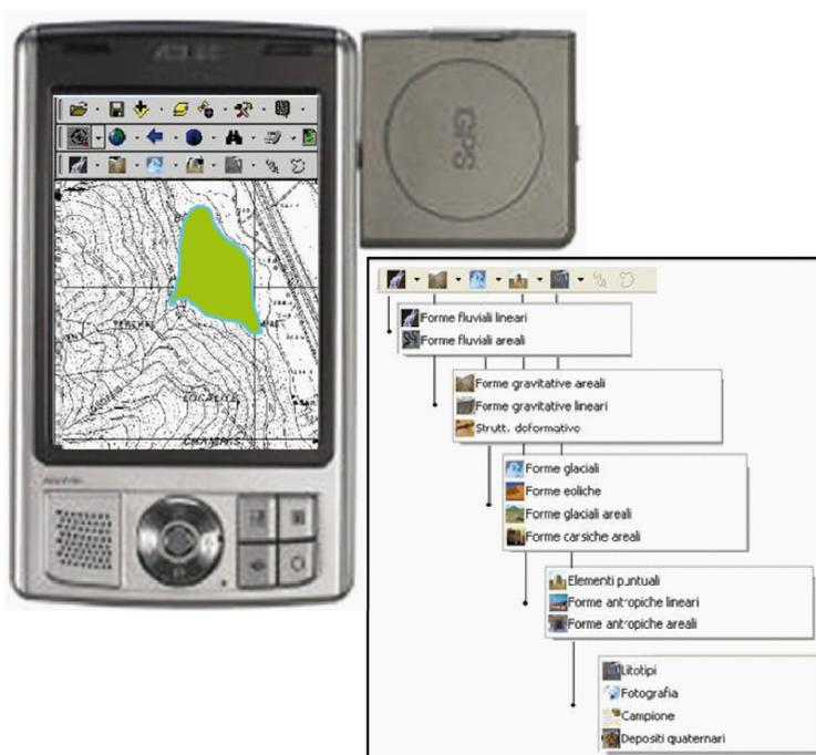
Figura 2 – Esempio di pocket-PC e di toolbar SRG2 (Supporto al rilevamento Geologico e Geomorfologico) per il lavoro sul terreno.
