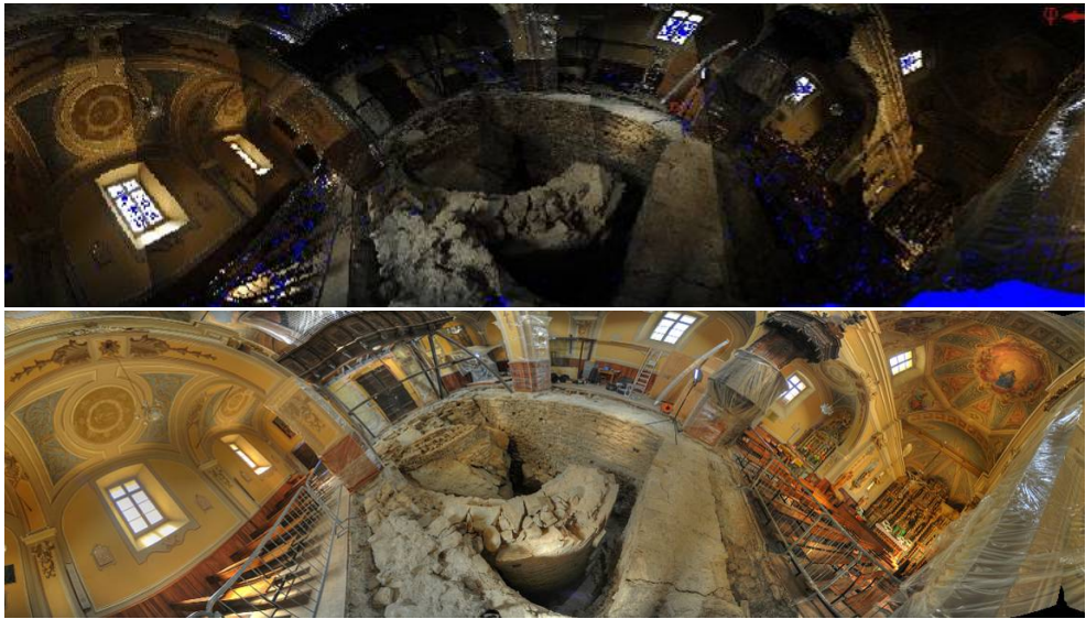
Figura 5 – Vista panoramica della scansione laser colorata utilizzando le immagini digitali classiche (in alto) e utilizzando le stesse immagini elaborate con la tecnica messa a punto da Ad hoc 3D Solutions srl (in basso).
