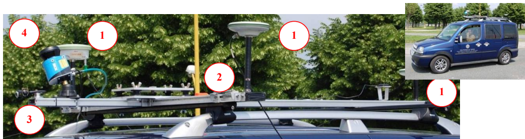
Figura 1 – Sistema mobile mapping utilizzato e sensori installati.
