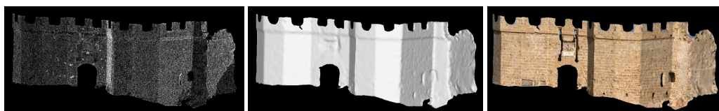
Figura 15 – Visualizzazione per punti (a sinistra), shaded (centrale) e con texture (a destra) del modello 3D della Porta Aragonese.
