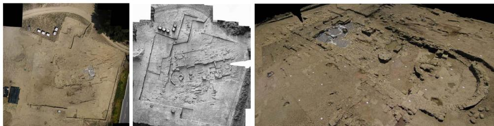
Figura 9 – Area archeologica di Pava (Siena) rilevata con un UAV Microdrone MD4-200 e DSM generato con tecniche automatiche di image matching.
