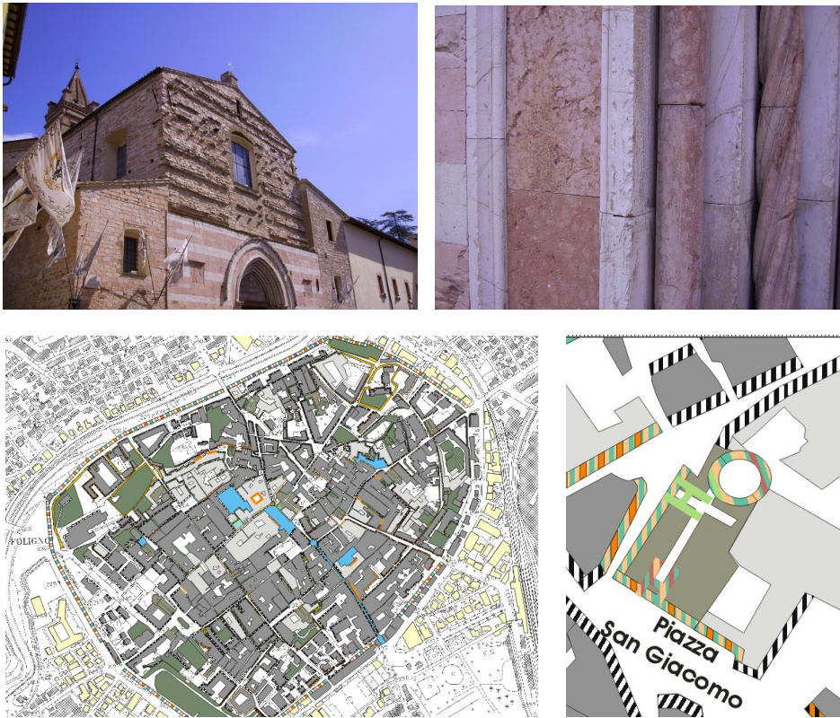
Figura 5 – Esempio di trasferimento dei dati litologici dal monumento alla carta: visione d'insieme e dettaglio del portale della chiesa di S. Giacomo, dove si riconoscono le rocce della Formazione della Scaglia Bianca e del Rosso Ammonitico della Serie Umbro-Marchigiana dell'Appennino umbro. Segue la rappresentazione planimetrica della carta di Geologia Urbana della città di Foligno e dettaglio della stessa, nella quale si evincono, attraverso la grafica e i colori, la tipologia edilizia e il litotipo utilizzato (Gregori & Beddini, 2011; foto Beddini).
