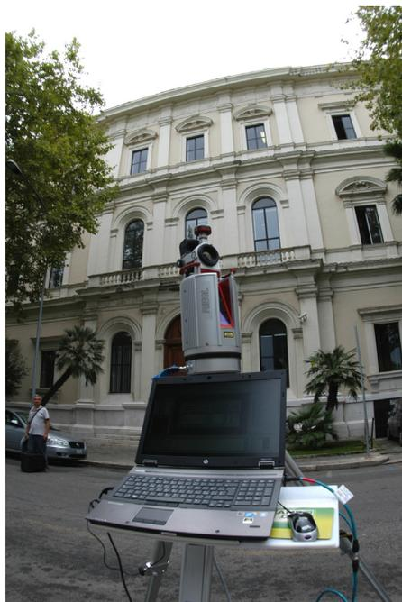
Figura 2 – Un esempio di condizione operativa con scanner laser Riegl Vz-400.
