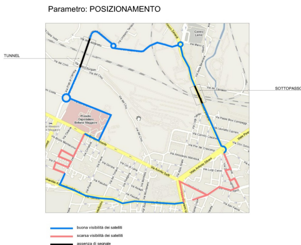
Figura 1 – Mappa del poligono di calibrazione indicante le zone con buona visibilità satellitare, zone generalmente caratterizzate da scarsa visibilità satellitare e tunnel.
