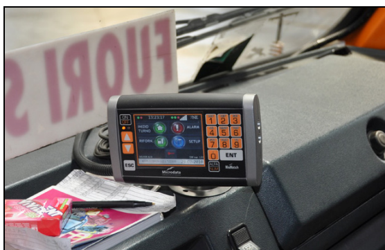
Figura 2 – Terminale di bordo e sua installazione nei mezzi ACAP.
