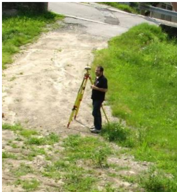
Figura 3 – Stazione GPS master.
