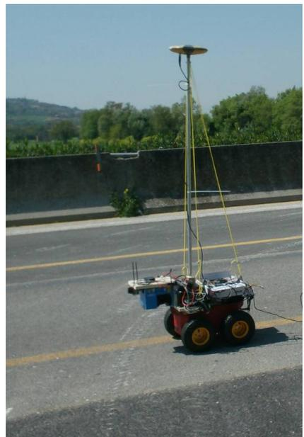
Figura 3 – Sistema di acquisizione per scansione georeferita; in primo piano il robot P3-AT usato per effettuare la scansione del profilo longitudinale.
