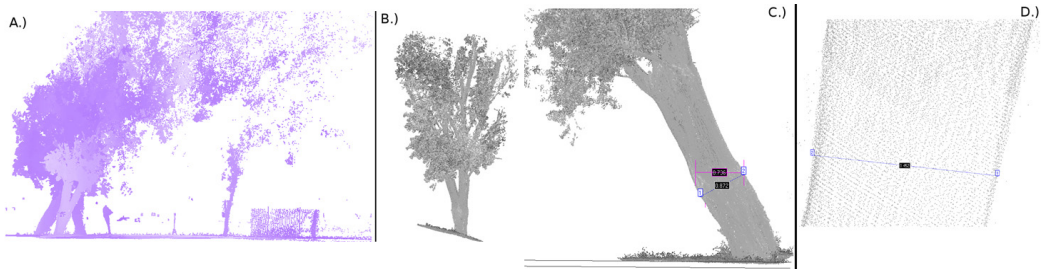
Figura 1 – Parti di elaborazione da laser scanner terrestre; A. il rilievo dell'area; B. inquadramento dell'elemento di interesse; C. misure dirette; D. dettaglio.
