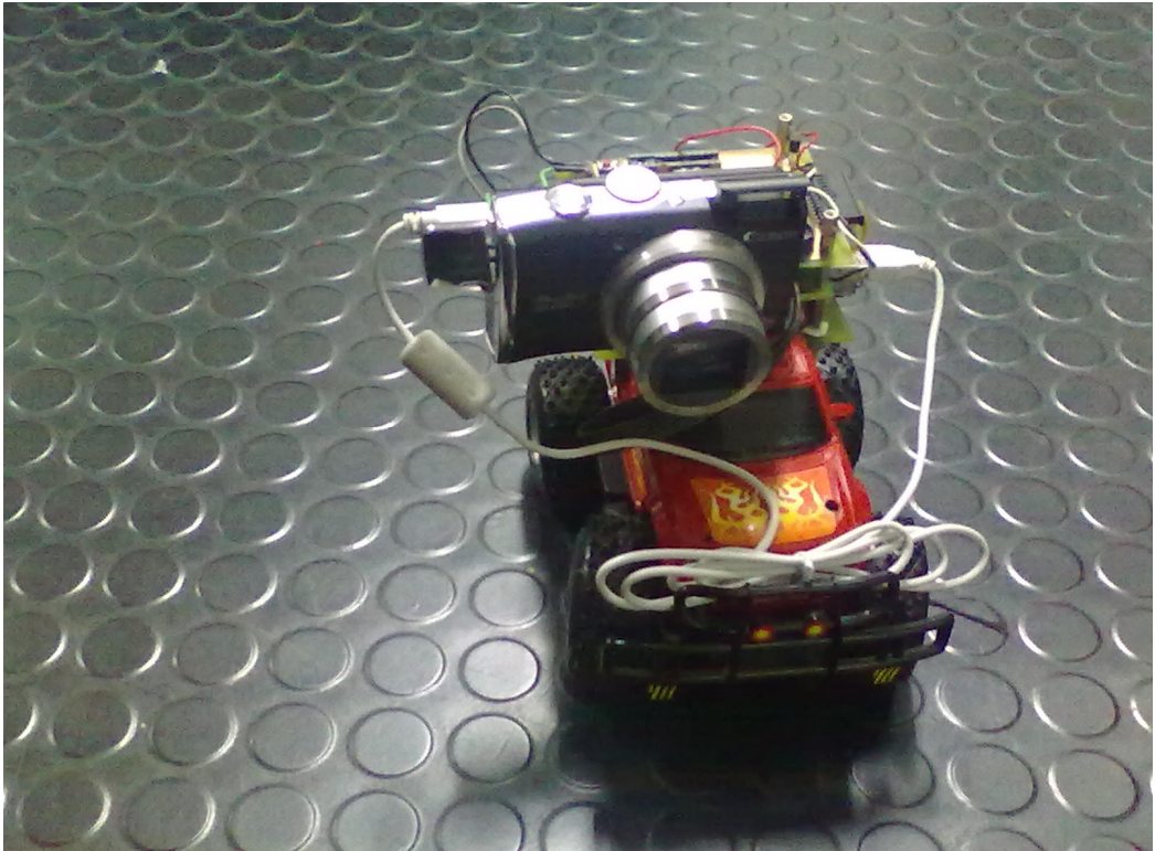
Figura 1 – La fotocamera assemblata con inerziale e wireless installata su modellino elettricoradiocomandato.
