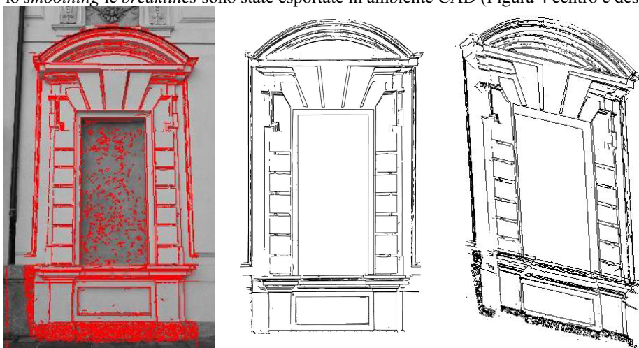
Figura 4 – Breakline estratte sull'immagine di riferimento (sx), risultato finale del processo di matching (centro, dx).
