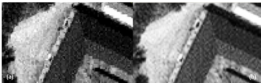
Figura 6 – Particolare delle ortofoto generate con algoritmo di ricampionamento di tipo Nearest Neighbor (a) e Cubic Convolution (b).
