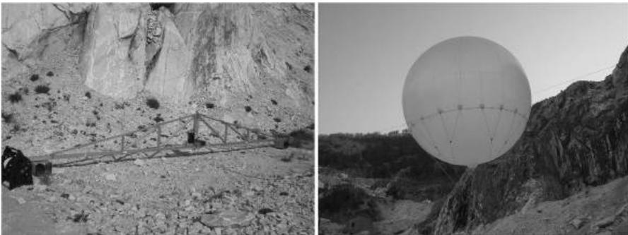
*Figura 3 – Supporto in alluminio che ospita le due macchine fotografiche digitali Reflex Nikon D80 e pallone aerostatico ad elio in volo.*
