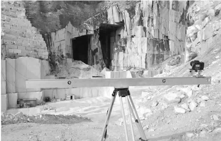
*Figura 2 – Barra calibrata per rilievo fotogrammetrico terrestre.*
