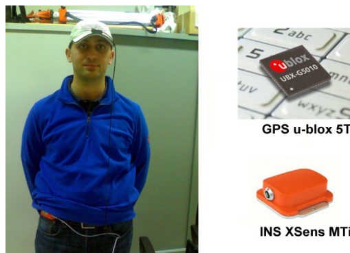
Figura 4 – Configurazione adottata per il test: sulla visiera del cappello è possibile notare l'antenna del ricevitore GPS, mentre sulla cintura è fissato il sensore inerziale.
