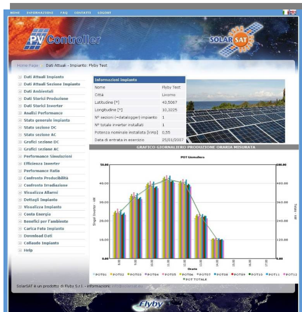
Figura 5 – Esempio di interfaccia grafica relativa a un impianto monitorato.
