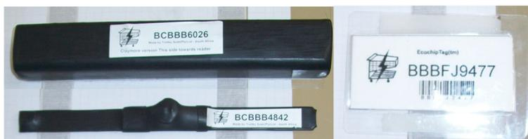
*Figura 2 – Diverse tipologie di trasponder: claymore (alto a sinistra), stick-tag(basso a sinistra) e card (a destra).*
