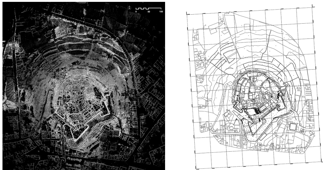
Figura 1 – A sinistra, vista planimetrica della Cittadella e dell'area ad essa circostante ottenuta dalla nuvola di punti del modello tridimensionale; a destra, planimetria della Cittadella e dell'area ad essa circostante ottenuta dal rilievo integrato. L'elaborato vettoriale mostra la griglia del sistema cartografico nazionale UTM.
