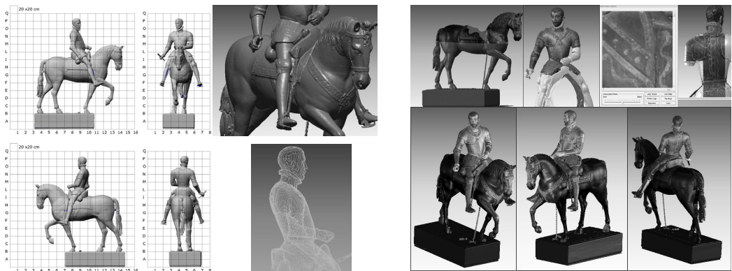
Figure 4-5 – Modello digitale 3D della statua equestre e applicazione delle texture per procedura DLT. Il modello è caratterizzato da una precisione della superficie modellata che consente anche la lettura di dettagli con dimensioni intorno ai 4mm. L'utilizzo dello stesso per finalità di visualizzazione e georeferenziazione dati è stato utile per le fasi di restauro (2009) successive al rilievo e per la documentazione digitale del bene per web users.
