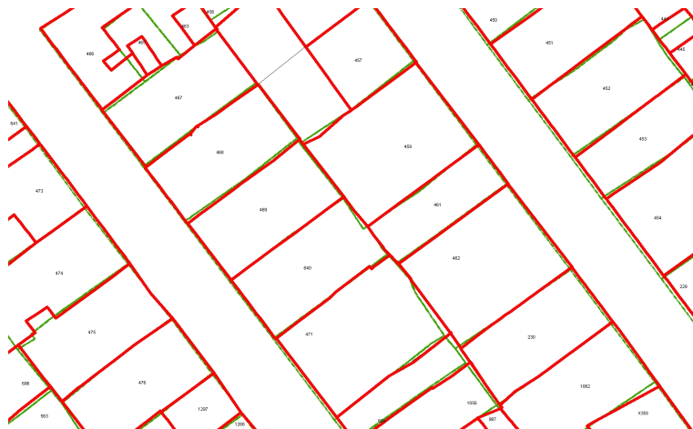
Figura 5 – Scostamenti tra le geometrie catastali originali e quelle generate a partire dalle geometrie del database.
