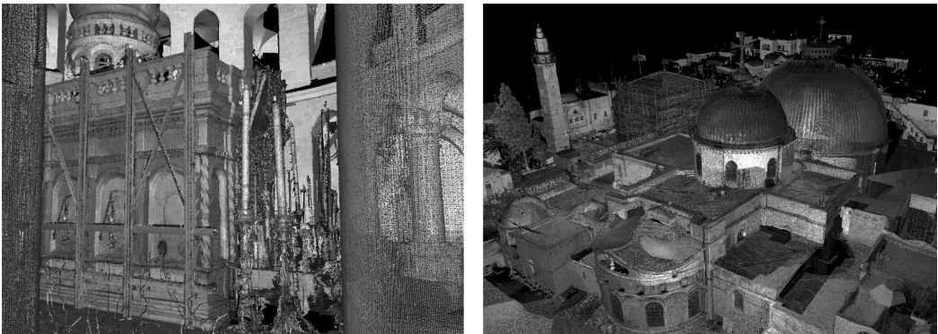
Figura 3 e 4 – L'edicola del Santo Sepolcro al centro della Rotonda (a sinistra) – Il rilievo delle coperture è esteso all'intero isolato (a destra). Viste del modello di punti.
